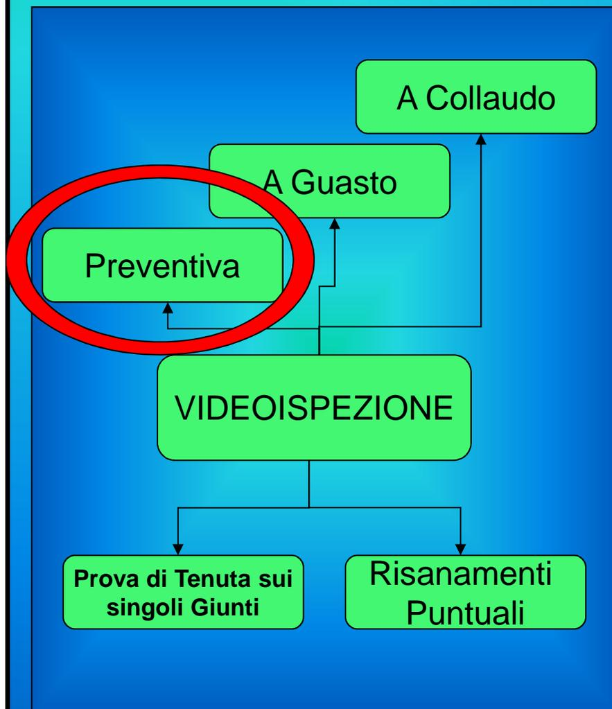
L'utilizzo pianificato della tecnologia videoispettiva è lo strumento principe per andare a reperire dati oggettivi da inserire nei GIS delle singole aziende di utilità.
